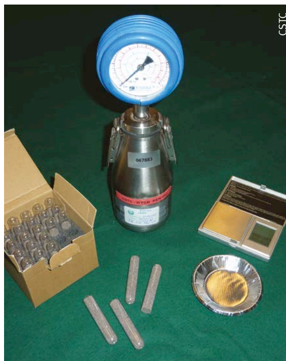
Fig. 2 La bombe à carbure : plus précise, mais plus contraignante à utiliser.
